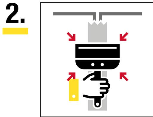
Coloque la cinta de refuerzo sobre la junta y presione con la espátula, quitando el exceso.
