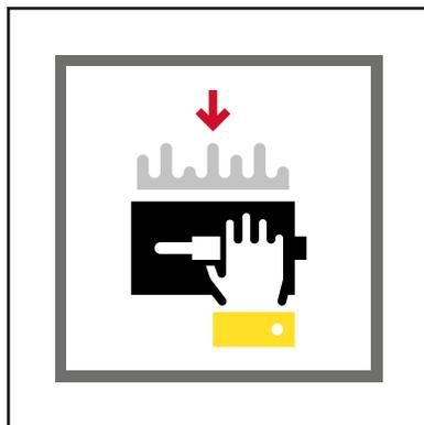
Con una llana metálica aplique una fina capa de masilla Supermastick PR<sup>®</sup> en el área a cubrir.
